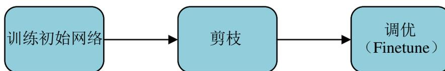
图 5.1 网络剪枝的三个步骤：训练初始网络 → 剪枝 → 调优 (finetune) 剪枝后的小网络。
